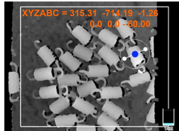
ばら積み部品の把持点認識処理例
